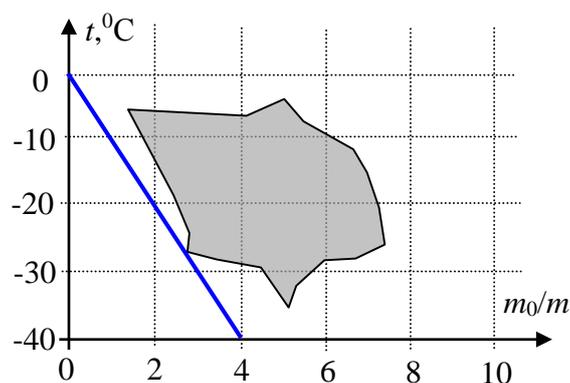
прямой, тем больше модуль произведения  $mt$ . Из графика видно, что для прямой проведенной из начала координат, касающейся области возможных параметров льда и имеющей максимальный угол наклона, значение коэффициента  $\alpha = -10^{\circ}\text{C}$ . Следовательно, максимальная масса пара потребуется при значении произведения  $mt = -10$  кг $\cdot^{\circ}\text{C}$ . С учетом этого, получим  $m_{\text{п}} \approx 6,9$  г.
