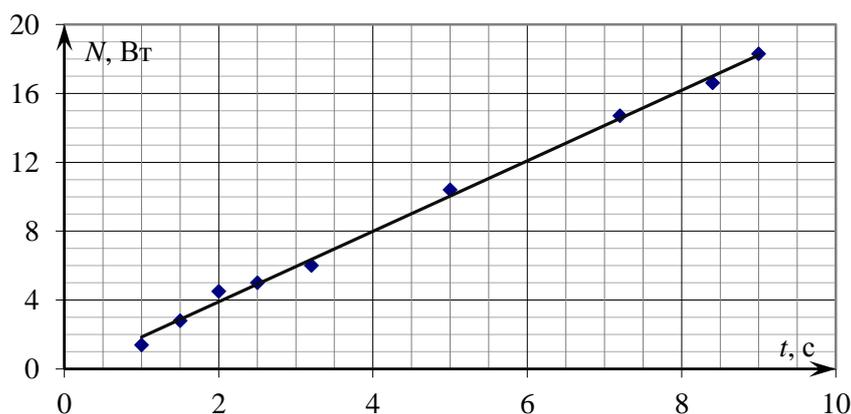
В момент времени  $\tau = 6$  с мощность должна составлять 12 Вт. По угловому коэффициенту наклона графика  $k = \frac{F^2}{m} = 2$  Вт/с определяем значение силы  $F = \sqrt{km} = 2$  Н.
