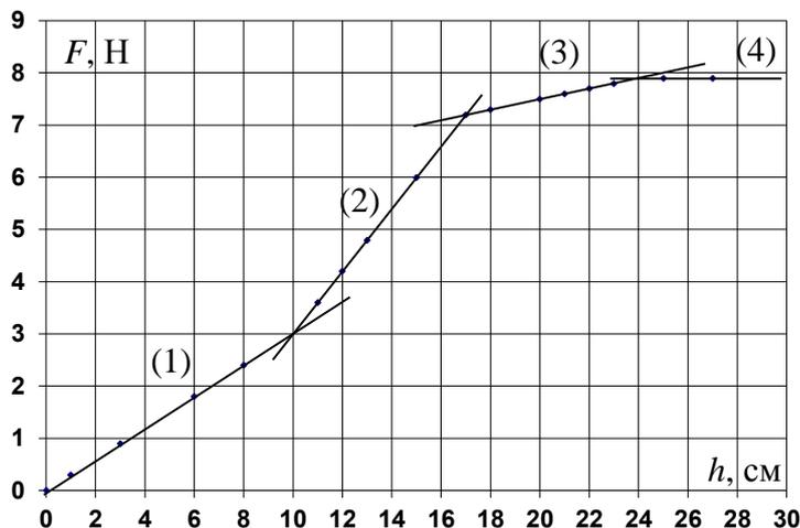
нельзя. В области с  $h < 24$  см самый пологий участок графика третий, следовательно, на нем наименьшая площадь поперечного сечения  $S$ . Угловой коэффициент наклона первого участка в три раза больше, следовательно, его сечение  $3S = 30 \text{ см}^2$ . На втором участке угловой коэффициент наклона больше в 6 раз, а его площадь сечения  $6S = 60 \text{ см}^2$ . Длины цилиндров 10 см, 7 см и 7 см соответственно. Плотность жидкости можно  $h$ , см
