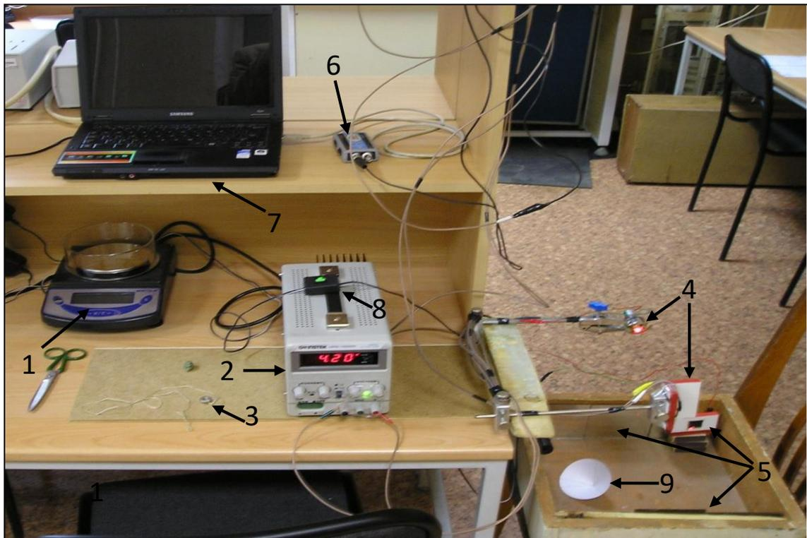
Установка позволяет с большой точностью определять время свободного падения бумажного конуса на участке, где движение конуса является равномерным. Для измерения времени движения конуса используется система из двух сборных фотодатчиков (верхнего 4 и нижнего 5), сигнал с которых через USB-осциллограф 6 поступает в ноутбук 7.
