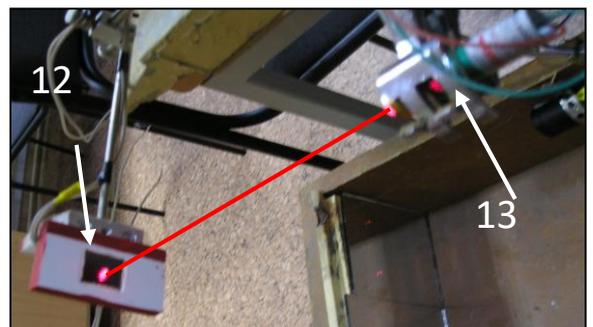
Нижний сборный фотодатчик представляет собой квадратный ящик к двум противоположным стенкам которого изнутри приклеены плоские зеркала. На боковой стенке ящика закреплен лазер 10, луч которого, многократно отразившись от зеркал, попадает на фотоэлемент 11, двигаясь все время в одной горизонтальной плоскости. При падении конуса внутрь ящика луч лазера гарантированно перекрывается и напряжение на фотоэлементе изменяется.
