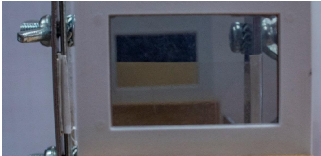
Рис. 1. Наблюдение глазом скотча, растянутого между скрещенными поляризаторами.
