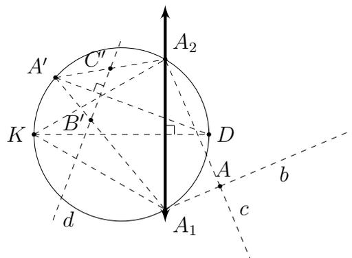
Главный оптический центр линзы  $O$  получим как точку пересечения отрезка  $AA'$  с плоскостью линзы. Восстановим главную оптическую ось линзы как перпендикуляр к её плоскости. Далее, опустим из точек  $A$  и  $A'$  перпендикуляры на плоскость линзы. Соединим основания перпендикуляров с точками  $A'$  и  $A$ . Точки пересечения последних отрезков с главной оптической линзы являются её фокусами  $F_1$  и  $F_2$ .
