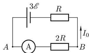
Мысленно отсоединим часть цепи, содержащую батарейку с ЭДС  $2\varepsilon$ . Тогда сила тока, протекающего в оставшемся контуре (рис. 30), будет равна:
