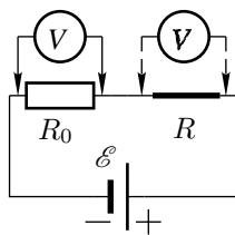
С помощью вольтметра определяем падение напряжения  $U_0$  на резисторе с известным сопротивлением и напряжение  $U$  на стержне. Сопротивление образца рассчитываем по формуле:
