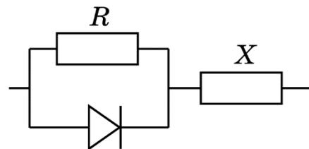
Участок цепи с параллельно соединёнными диодом и резистором имеет вольтамперную характеристику, изображённую ниже.
