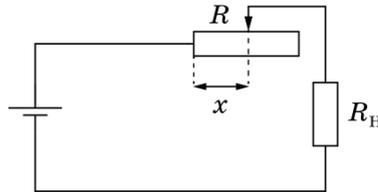
При температуре внешней среды  $t_1 = 25^\circ\text{C}$  для поддержания требуемой температуры ползунок реостата стоит в положении  $x_1 = 0,65$ , при  $t_2 = 20^\circ\text{C}$  ползунок реостата стоит в положении  $x_2 = 0,35$ . Какой должна быть величина  $x$  при температуре внешней среды  $t_3 = 13^\circ\text{C}$ ? Мощность тепловых потерь пропорциональна разности температур термостата и окружающей среды.
