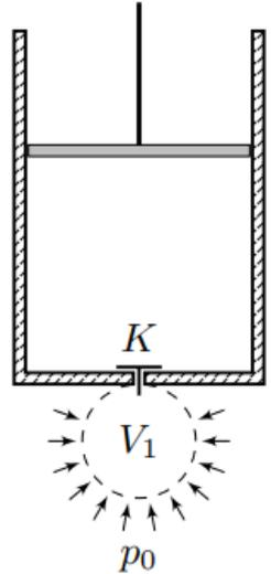
Работа внешнего давления над поршнем равна  $p_0\Delta V_1$ . Закон сохранения энергии:
