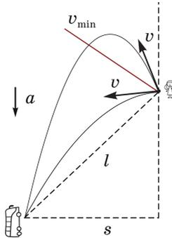
Тогда задача сводится к поиску времен движения тела с заданными начальной скоростью и ускорением в точку, находящуюся на расстоянии  $s$  по горизонтали и  $\sqrt{l^2 - s^2}$  по вертикали. Минимальное время достигается при движении по «настильной» траектории. При таком подходе интуитивно понятным становится ОДЗ – не при любой начальной скорости тело сможет долететь до заданной точки.
