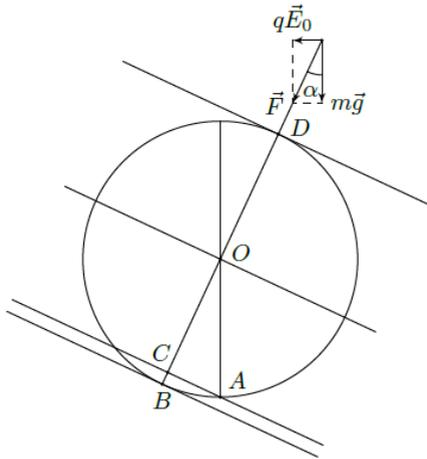
Поле силы тяжести и электростатическое поле однородны, поэтому на шарик будет действовать постоянная равнодействующая  $F$ , направленная под углом  $\alpha$  к вертикали.  $x = \operatorname{tg} \alpha = \frac{E_0q}{mg}$ ,  $F = \frac{mg}{\cos \alpha} = mg\sqrt{x^2 + 1}$ . При действии постоянной силы потенциальная энергия определяется как  $W_{\text{пот}} = Fh$ , где ось  $h$  направлена противоположно направлению силы.
