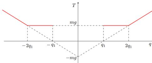
При  $\frac{q\sigma}{\varepsilon_0 mg} \geq 4$  устойчиво положение равновесия  $\alpha = 0^\circ$ , а при  $2 < \frac{q\sigma}{\varepsilon_0 mg} < 4$  устойчиво равновесие с  $\alpha_2 = \arccos\left(\frac{q\sigma}{2\varepsilon_0 mg} - 1\right)$ . Для случая  $\alpha_1 = 0^\circ$  при отклонении шарика на малый угол  $\varphi$  от положения равновесия возникает возвращающая сила, проекция которой на ось  $x$ , перпендикулярную нити равна:
