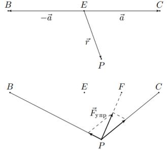
Таким образом, равнодействующая сила всегда направлена к точке  $F$ , являющейся серединой отрезка  $EC$  (рис.2), и пропорциональна расстоянию до неё от точки  $P$  с коэффициентом жёсткости  $4k$ . Следовательно, всё движение шайбы будет происходить по прямой  $OF$ , как если бы она находилась под воздействием пружины с коэффициентом жесткости  $4k$  и имела положение равновесия в точке  $F$ .
